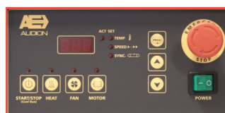
Panneau de contrôle avec affichage digital de la température de soudure
